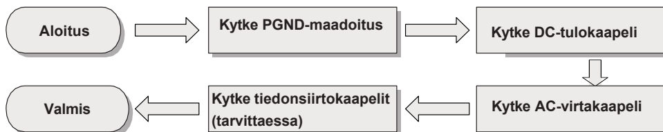
Kuva 4-1 invertterin kaapeleiden kytkentäjärjestys
