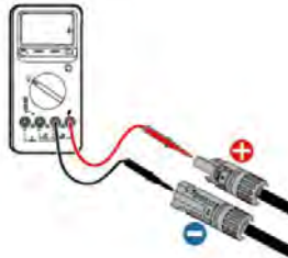
Kuva 5-15 Tarkista yleismittarilla positiivinen ja negatiivinen elektrodi
